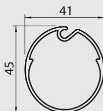
Tuchwelle M40 für Elektroantrieb (Aluminium)
