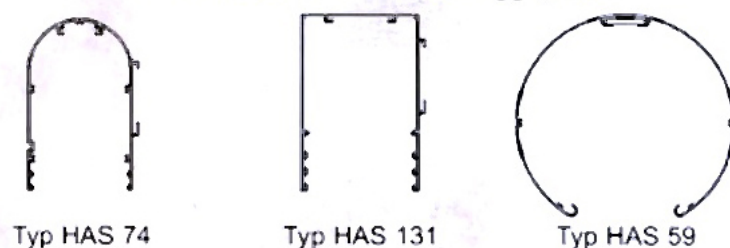
Blenden aus Aluminium stranggepresst
