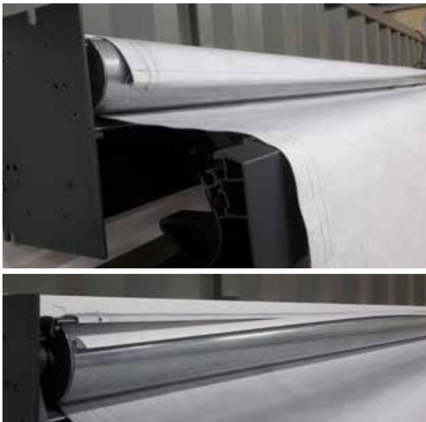
13. Das Tuch auf der Welle verteilen, indem das Tuch bündig mit dem Motor gelegt oder bis zur Seitenplatte abgemessen wird.
