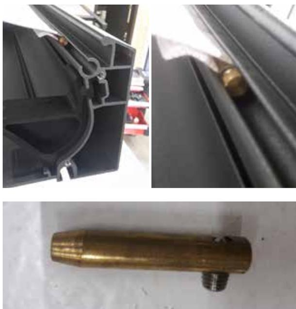
7. Endpunkte der Fallstange in ausfahrende Richtung schieben, damit sich das Clip-on-Profil auf der Welle abnehmen lässt. Anm. Bei RTS oder IO: Nach dem Öffnen nicht vergessen, neue Position am Motor zu bestätigen. Das Tuch kann jetzt eventuell aufgerollt und zwischen Kasten und Fallstange gelegt werden.
