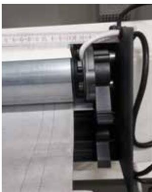
14. Das Tuch langsam zurück auf die Welle laufen lassen und kontrollieren, ob die Arme übereinander liegen. Dies so lange, bis auf den Tüchern keine Spannung mehr ist und sie entfernt werden können. Tücher von den Armen entfernen (siehe Punkt 1).
