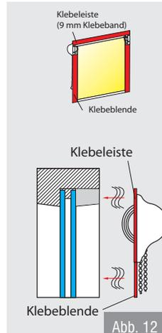
**Abb. 12:** Entfernen Sie die Schutzfolie der Klebeblende wie Abb. 10. Drücken Sie die Klebeblende und -leiste (an der Kassette) auf die Glasleiste. Dann Kettenhalter montieren.
