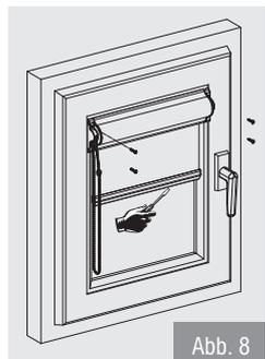
**Abb. 7, 8:** Verschrauben Sie die Kassette auf dem Fensterrahmen.
