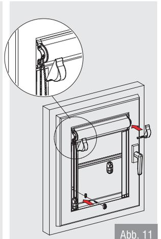
**Abb. 11:** Schieben Sie die Endkappen auf die montierte Kassette. Danach können Sie den Kettenhalter montieren
