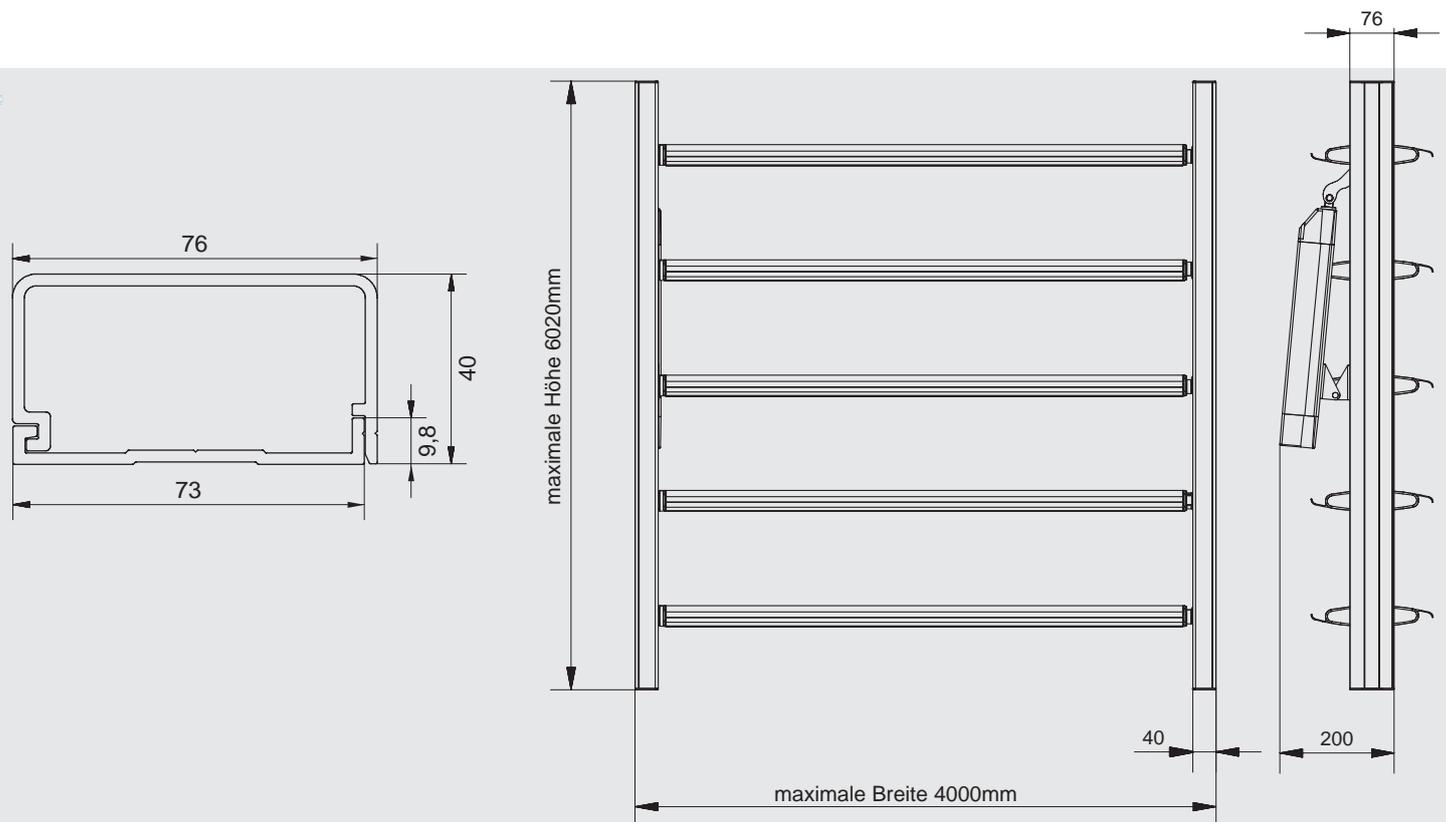
Die Lamellen und die Führungsschienen des Systems **Sunbreaker** sind aus extrudiertem Aluminium hergestellt.
