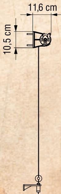
Geringe Abmessungen für das Außenrollo erlauben die unauffällige Integration des Sonnenschutzes.
