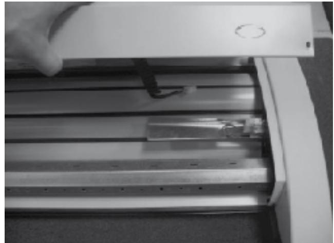
De spiraalkabelstekker zoals afgebeeld in de passende connector steken.
