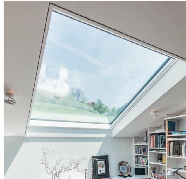
Die Fixverglasung s: 209 lässt sich als Oberlicht in sämtliche Dachformen äusserst diskret und ästhetisch einbauen. Mit seinen grosszügigen Dimensionen von bis zu 6000 × 3000 mm (je nach Dachneigung, Einbauort und Gebäudestatik) lässt sich ein neues Raumgefühl erleben. Das Oberlicht ist als Zwei- oder Dreifach-Isolierglas erhältlich und weist dank der Glasstufe von aussen nur einen minimal sichtbaren Blechanteil auf.
