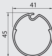
Tuchwelle M40 für Elektroantrieb (Aluminium)
