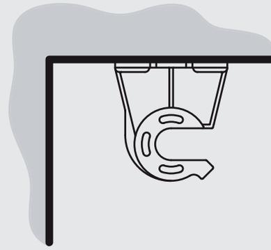
**Bei Deckenmontage ist keine Seilführung möglich. Die freihängende Ausführung ist nur für Innen möglich**
