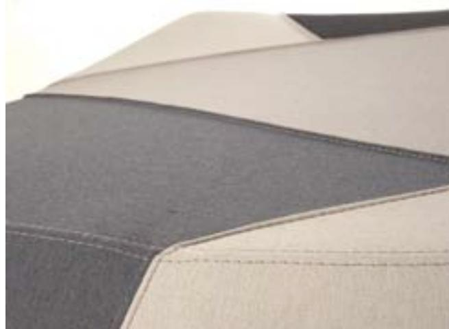
Die neuartigen Textilien bestehen aus bis zu 50 Prozent recycelten, spinndüsengefärbten Acrylfasern.
