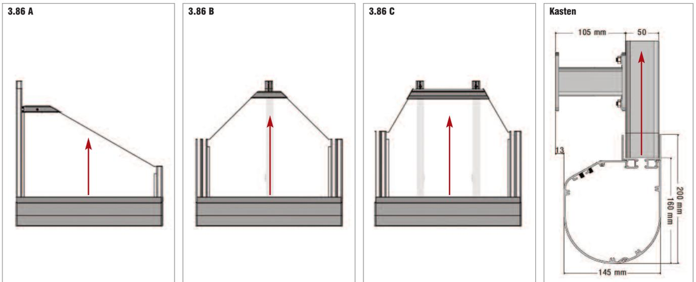
**max. Baubreite:** **600 cm** (bei Breiten über 400 cm techn. Prüfung erforderlich)
