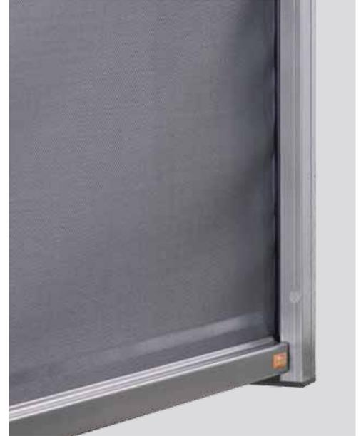
Reißverschlussgeführte Tücher weisen speziell im Randbereich leichte Wellen auf. Diese sind ebenfalls konzeptbedingt und nicht abstellbar, da Tuch und Reißverschluss übereinander liegen und beim Wickeln unterschiedliche Wege zurücklegen. Hierdurch wird das Tuch beim Wickeln durch den Reißverschluss gestaucht, was beim Abwickeln als Welle oder gar Knick sichtbar wird.
